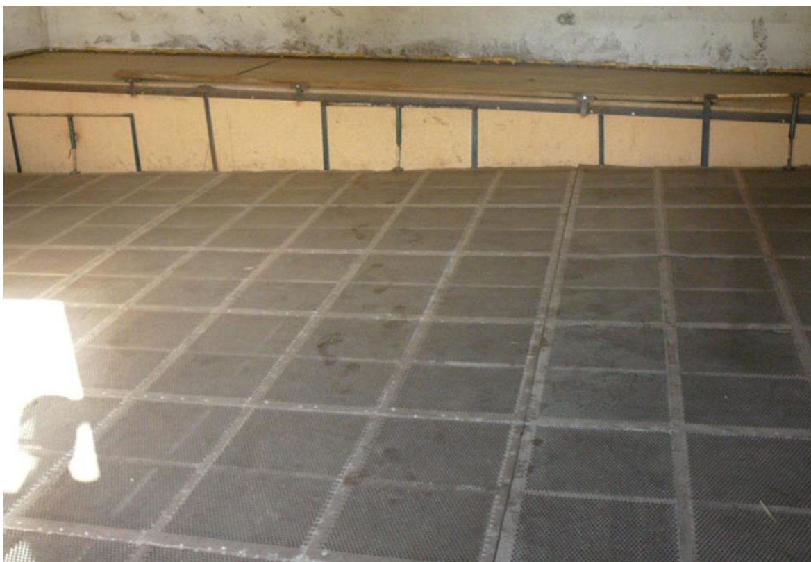
Fot.9. Suszarnia komorowa. Na pierwszym planie podłoga sitowa, w głębi kanał, przez który doprowadzane jest ogrzane powietrze.
