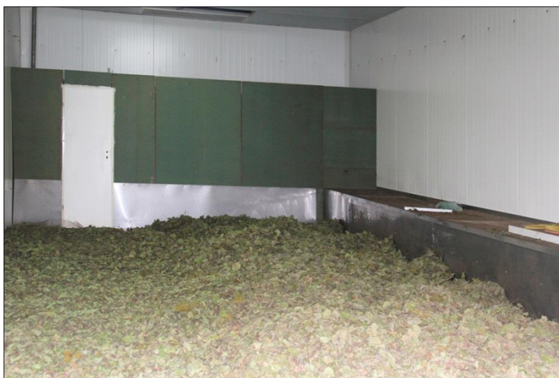
Fot.13. Suszenie ziela w suszarni komorowej. Po prawej kanał, przez który doprowadzane jest ogrzane powietrze.
