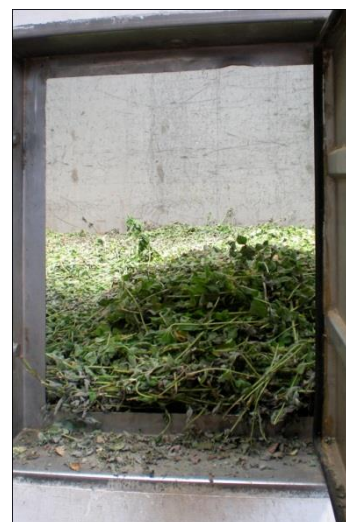
Fot.14. Suszenie ziela w suszarni komorowej.
